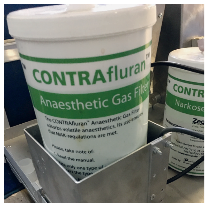
Bild 7: Der Aktivkohlefilter wird am Ausgang sensorisch überwacht
